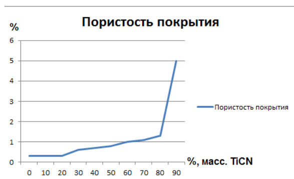
Рисунок 81. Зависимости пористости покрытия от содержания армирующей компоненты TiCN в композиционном порошке для напыления.
