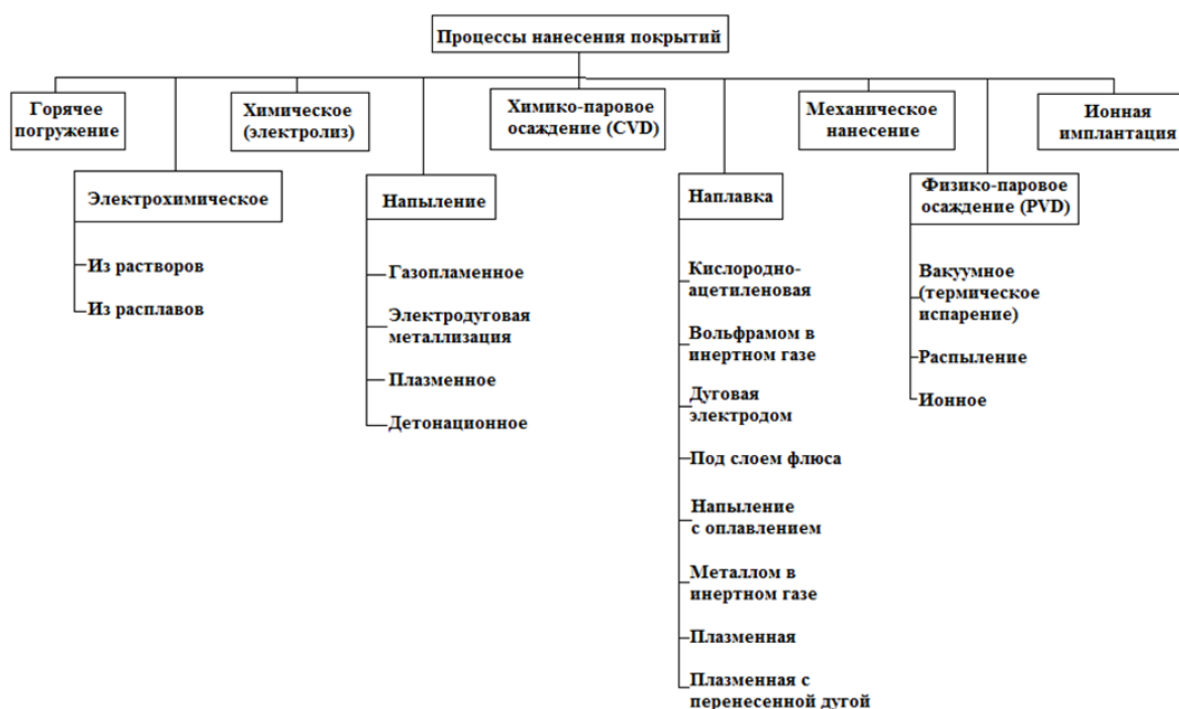
Рисунок 1. Классификация процессов нанесения металлических покрытий [1].
