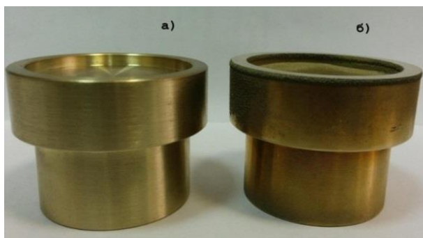
Рисунок 94. Имитатор тарелки клапана без покрытия а) и с покрытием на основе бронзы б).
