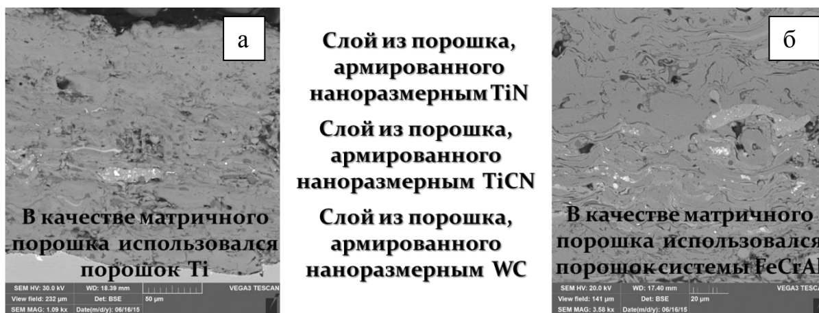
Рисунок 84. Изображения поперечных шлифов ФГП, полученных чередованием композиционных армированных порошков на основе матриц из Ti а) и сплава Fe-Cr-Al б).
