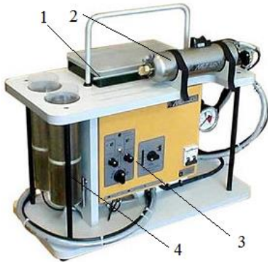
Рисунок 16. Внешний вид установки «Димет 403», где 1- установленное сопло; 2- напылитель ДМ-43; 3- блок контроля и управления БКУ-03; порошковый питатель ПВ-43
